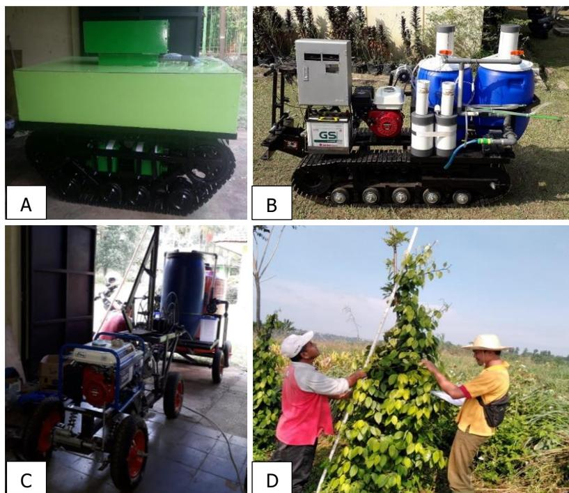
Gambar 23. A. konstruksi robot fertigasi 2018, B. robotfertigasi 2019, C. Modifikasi pengembangan tahun 2020, D. aktivitas pengamatan respon panjang sulur dan jumlah sulur
