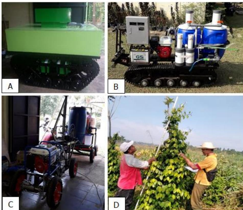
Gambar 24. A. konstruksi robot fertigasi 2018, B. robot fertigasi 2019, C. Modifikasi pengembangan tahun 2020, D. aktivitas pengamatan respon panjang sulur dan jumlah sulur
